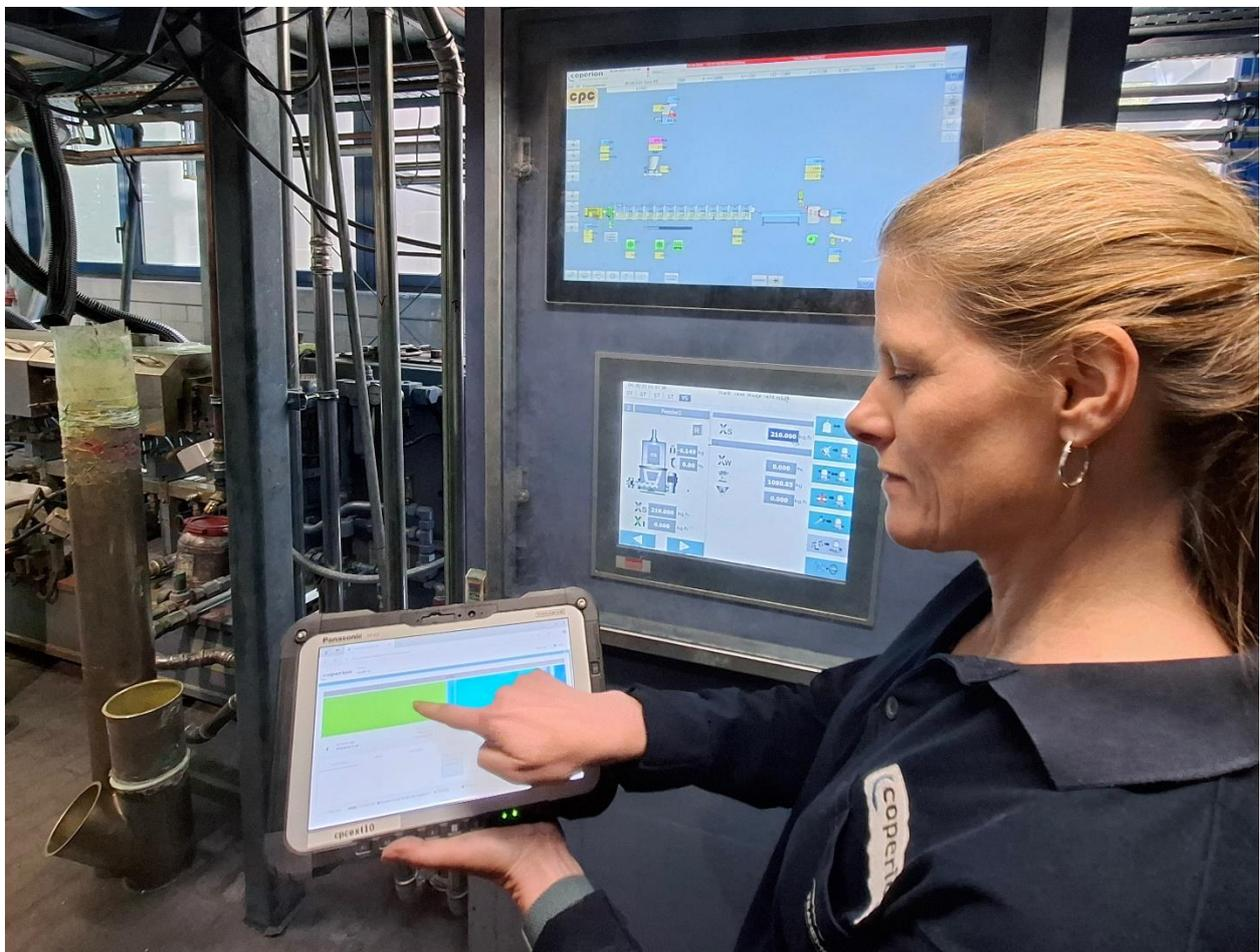
Die digitale Serviceplattform C-BEYOND ist ein wichtiger Bestandteil der Produktionsplanung bei cpc. Über Tablets am ZSK Extruder kann das Bedienpersonal jederzeit Rückmeldung zum Produktionsstatus an das System übergeben.
