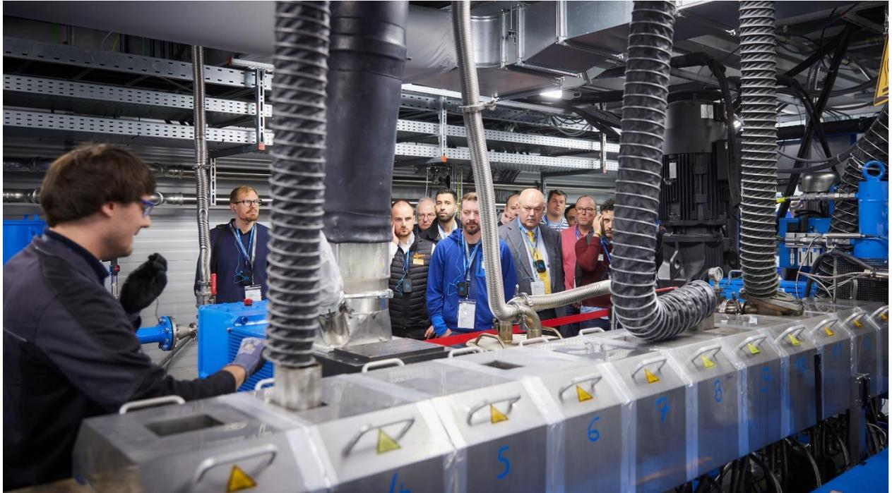
Die Live-Vorführung rund um einem ZSK 58 Mc<sup>18</sup> Recycling-Extruder zeigte eindrucksvoll, wie dank innovativer Zusatzaggregate rPE-Flakes trotz ihrer geringen Schüttdichte mit äußerst hohen Durchsätzen zu rPE-Granulat verarbeitet werden können.
