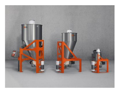
ProRate PLUS kontinuierliche gravimetrische Einfachschneckendosierer sind ideal für die Dosierung von Pellets, Granulaten und anderen frei fließenden Schüttgütern in Kunststoffanwendungen.
