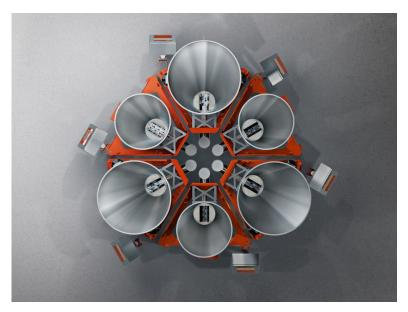
ProRate PLUS-Dosierer können je nach Rezeptur einzeln installiert oder in Gruppen von bis zu sechs Dosierern um einen Prozesseinlauf herum angeordnet werden.
