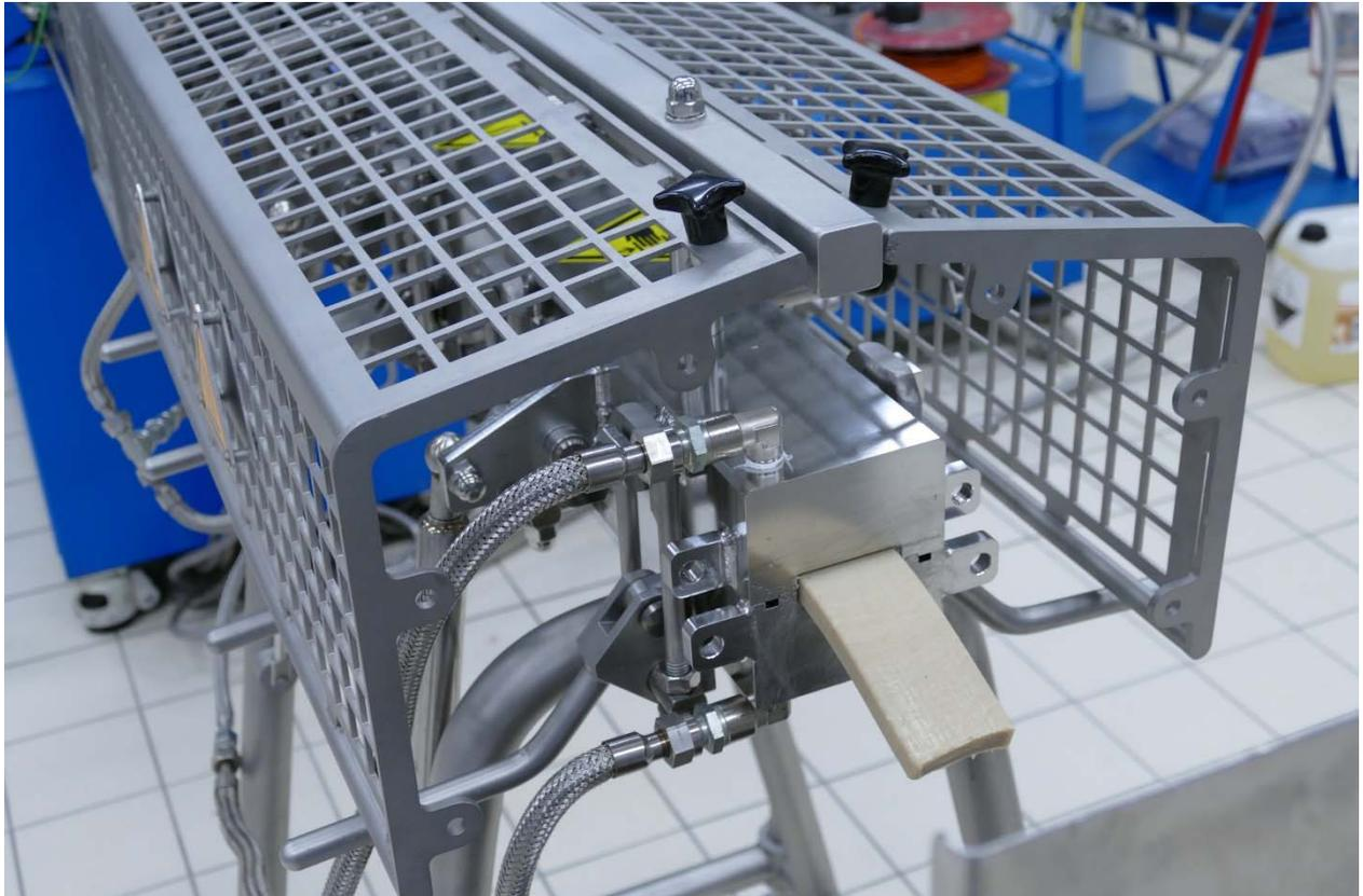
Austritt von High Moisture Meat Analogue (HMMA) aus der Kühldüse, die direkt an den ZSK Food-Extruder von Coperion angeflanscht wird.
