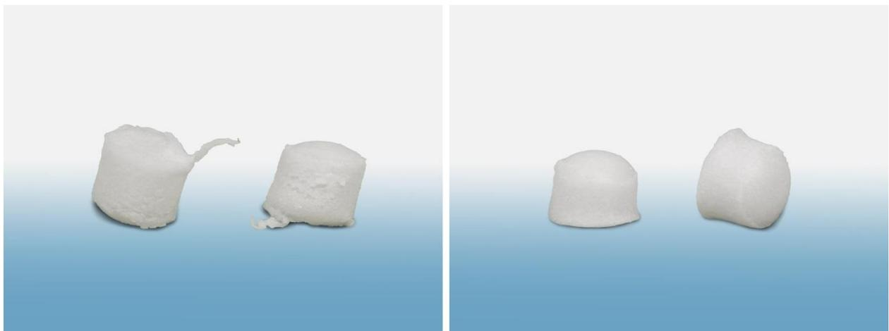
*Anders als bei herkömmlichen Messerflügeln (links) minimiert der neue EGR-Messerflügel von Coperion den Staubanteil im PVC-Granulat deutlich (rechts).*
