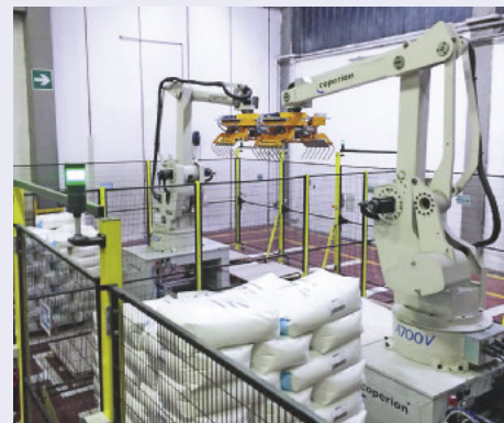
Die Palettierinsel ist mit zwei vierachsigen Robotern ausgestattet, die abgefüllte Säcke in 12 Palettierpositionen stapeln
