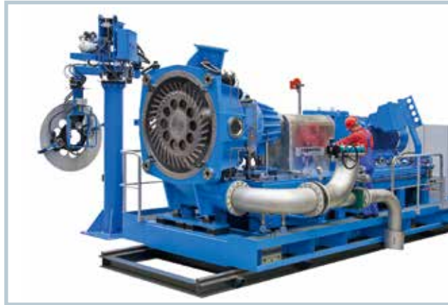
Bild 1. Am oberen Rand des heute Machbaren: Der Typ UG1250 ist für Durchsätze von bis zu 120 t/h ausgelegt
