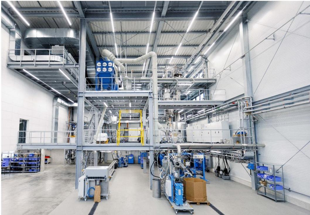
Coperion hat sein neues Recycling Innovation Center mit neuester Technologie für alle wesentlichen Prozessschritte der Rezyklierung ausgestattet – von der Materialförderung und Dosierung über die Extrusion, Compounding, Granulierung und Materialnachbereitung bis hin zur Desodorierung.
